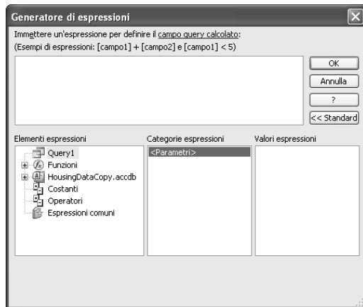
Figura 9-21 Finestra di dialogo Generatore di espressioni, che aiuta a creare espressioni semplici e complesse
